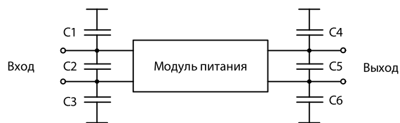
Рис. 2. Рекомендованная схема трансформации внутреннего высокочастотного сопротивления модуля питания
