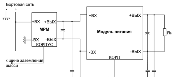
Рис. 3. Схема подключения модуля фильтрации МРМ к модулю питания в однопроводной сети
