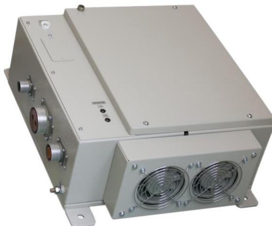
Блок питания предназначен для снабжения потребителей электроэнергией постоянного тока. Блок преобразует входное однофазное, трёхфазное напряжение переменного тока (БА4) или напряжение постоянного тока (БД4) в постоянное напряжение 12...68 В.
