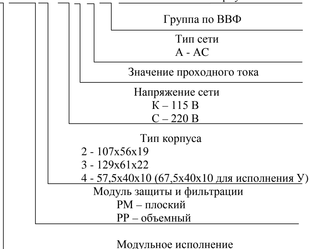
Рисунок 0.2 - Условное обозначение модулей защиты и фильтрации для работы в сетях переменного тока
