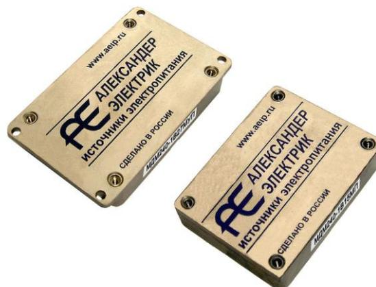
Низкопрофильные изолированные DC/DC модули электропитания серии МИРАЖ-П предназначены для жестких условий эксплуатации в технике промышленного и специального назначения. Отличительной особенностью модулей является возможность параллельной работы с выравниванием токов, открывающая перспективы для наращивания мощности и резервирования.
