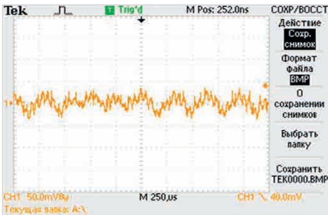
Рис. 7. Пульсации выходного напряжения двух параллельно включённых МП, работающих без синхронизации частоты преобразования
