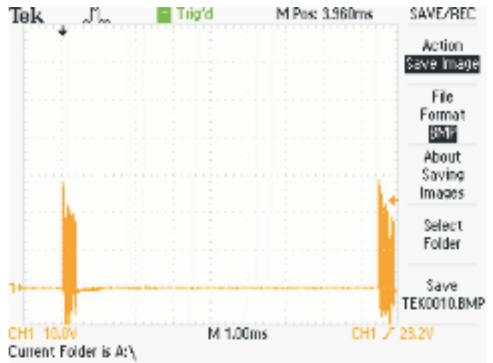
Рис.5. Работа ключа ОВН «пакетами» импульсов в режиме релаксации при коротком замыкании на выходе.
