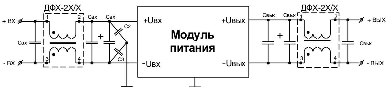
Схема включения одноканального модуля электропитания совместно с дросселями фильтрации
