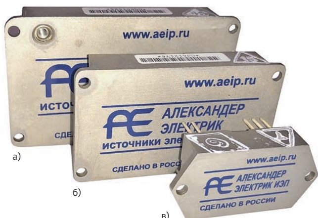
Рис. 2. Модули 15 Вт трех поколений а) МДМ (68×40×10), б) МДМ-П (58×33×10), в) МДМ-ЕП (40×20×9)
