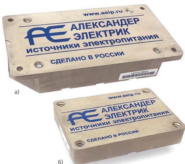
Рис. 3. Модули 40 Вт 1-го (а) и 2-го (б) поколения а) МАА40-СКН (107×56×17), б) МАА40-ПКМ (73×53×13)
